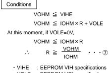
· VOLE : EEPROM VOL specifications VOHM : Microcontroller VOH specifications • IOHM : Microcontroller IOH specifications
